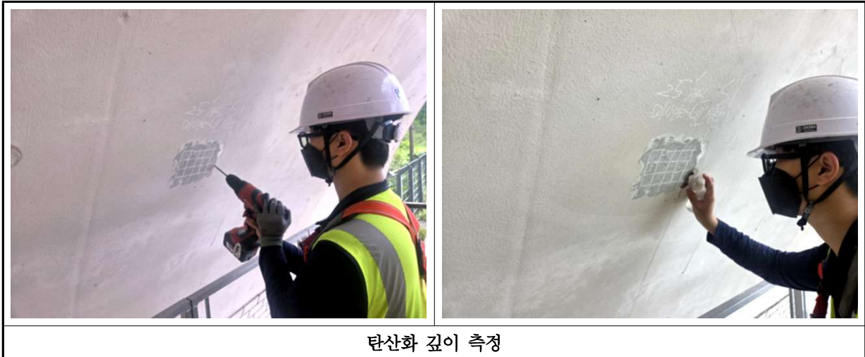
【사진 1.4.2】 탄산화 깊이 시험 현장사진
