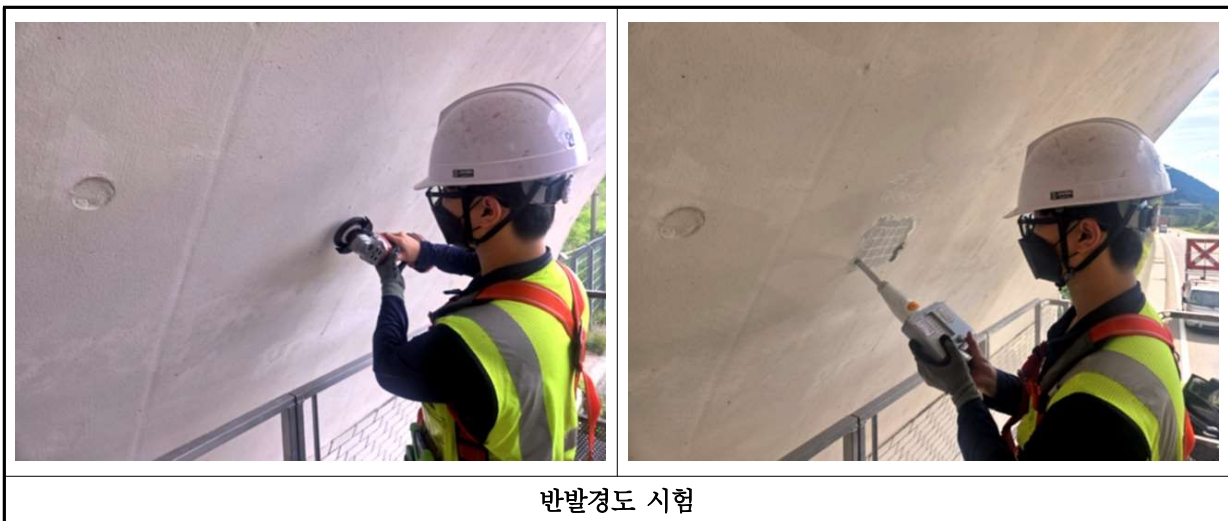
【사진 1.4.1】 강도시험 현장사진
